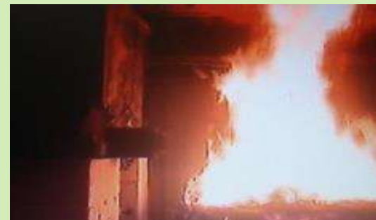
Chambre d'essai feu avec le colis de stockage contenant les 4 fûts d'enrobés (gauche). Essai feu réel agressant le colis de stockage (droite)
