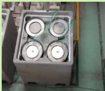
Colis de stockage béton instrumenté, contenant 4 Fûts métalliques d'enrobés de boues bitumées de 250kg chacun (gauche). Vue de détail de l'enrobé dans un fût (droite)
