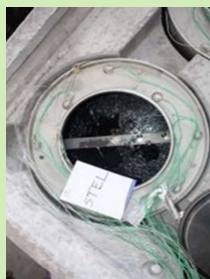
Colis de stockage béton instrumenté, contenant 4 Fûts métalliques d'enrobés de boues bitumées de 250kg chacun (gauche). Vue de détail de l'enrobé dans un fût (droite)
