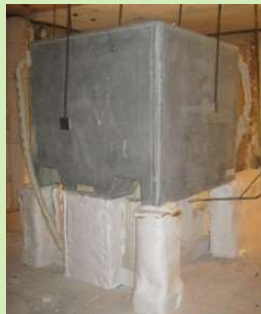
Chambre d'essai feu avec le colis de stockage contenant les 4 fûts d'enrobés (gauche). Essai feu réel agressant le colis de stockage (droite)
