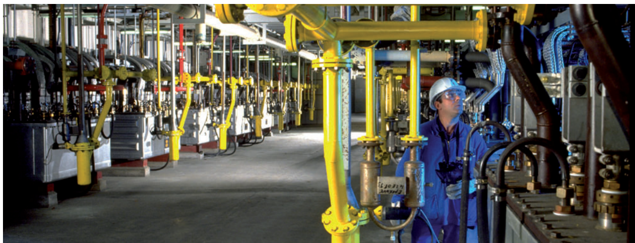
Cellules d'électrolyse de fluor. Usine de conversion de l' UF_4 en UF_6 de COMURHEX Pierrelatte sur le site du Tricastin
