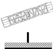
5<sup>ème</sup> chute est une chute horizontale sur de 1 mètre poinçon, avec impact au centre de l'emballage en évitant le capot central. Cette séquence permet de tester la résistance du corps de l'emballage et de valider la tenue de l'enceinte de confinement.
