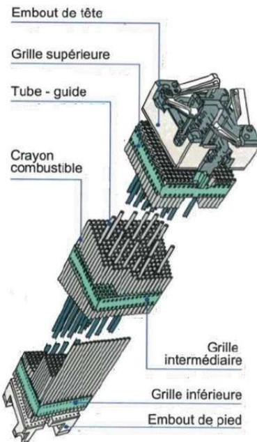
Le schéma de principe ci-contre illustre la constitution d'un assemblage combustible.
