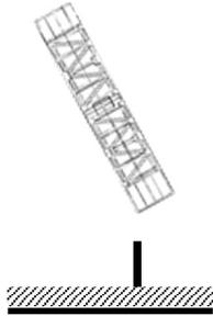
La 3<sup>ème</sup> chute est une chute oblique de 1 mètre sur poinçon sur capot de couvercle. Cette séquence permet de tester la résistance de la plaque de renfort du capot de couvercle, protégeant le système de fermeture.
