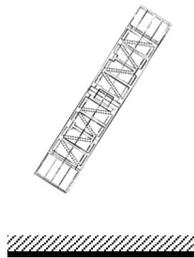
La 4<sup>ème</sup> chute est une chute oblique sur capot de couvercle de 9 mètres. Cette séquence permet de tester la capacité d'amortissement du capot et l'étanchéité du système de fermeture.
