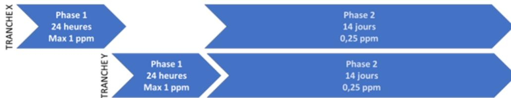
**Figure 3 Exemples de répartition des phases de traitement à la monochloramine des circuits CRF du site de Civaux**
