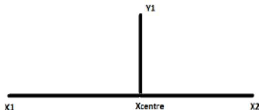
Figure 2 : objet test de position des lasers et de contrôle des longueurs et de la planéité du support du patient
