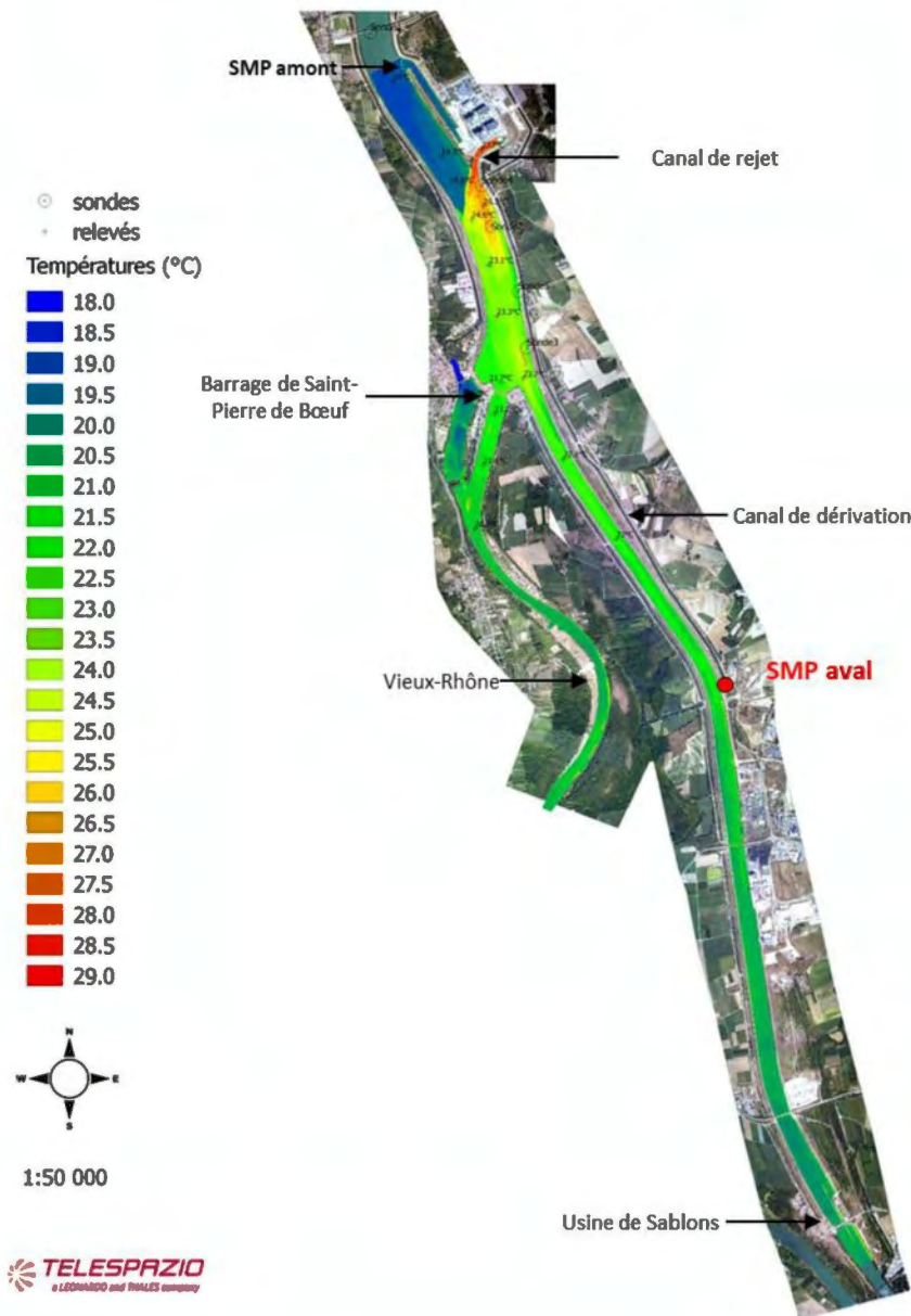
Figure 14 : Panache thermique acquis par infra-rouge le 06/07/2016 pour un débit moyen du Rhône de 860 m 3 /s et une température amont de 19,6°C. Le CNPE fonctionne à 95 % de puissance.
