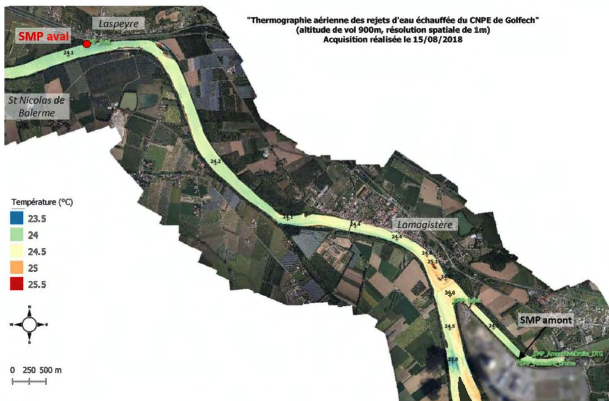
Figure 4 : Thermographie aérienne du panache thermique du CNPE de Golfech durant l'été 2018.
