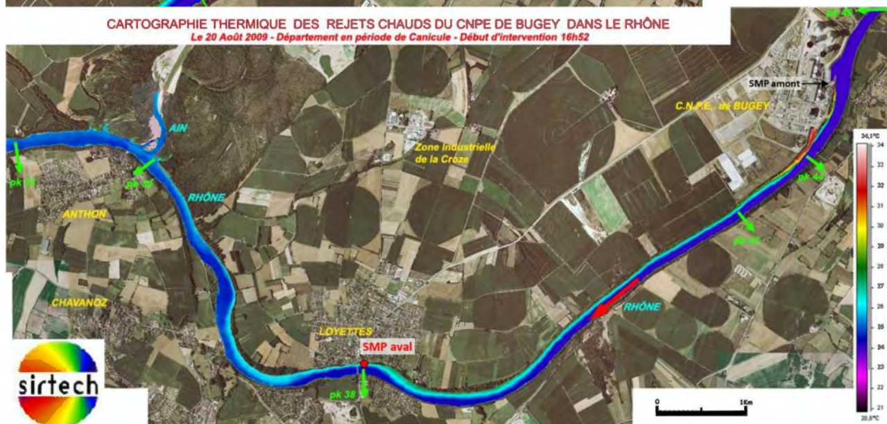
Figure 7 : Thermographie aérienne du panache thermique du CNPE de Bugey le 20 août 2009. Nota : contrairement à ce qui est indiqué sur la figure du haut, les rejets des réacteurs n°2-3 en circuit ouvert sont situés en aval des rejets des tranches 4-5 en circuit semi-fermé.
