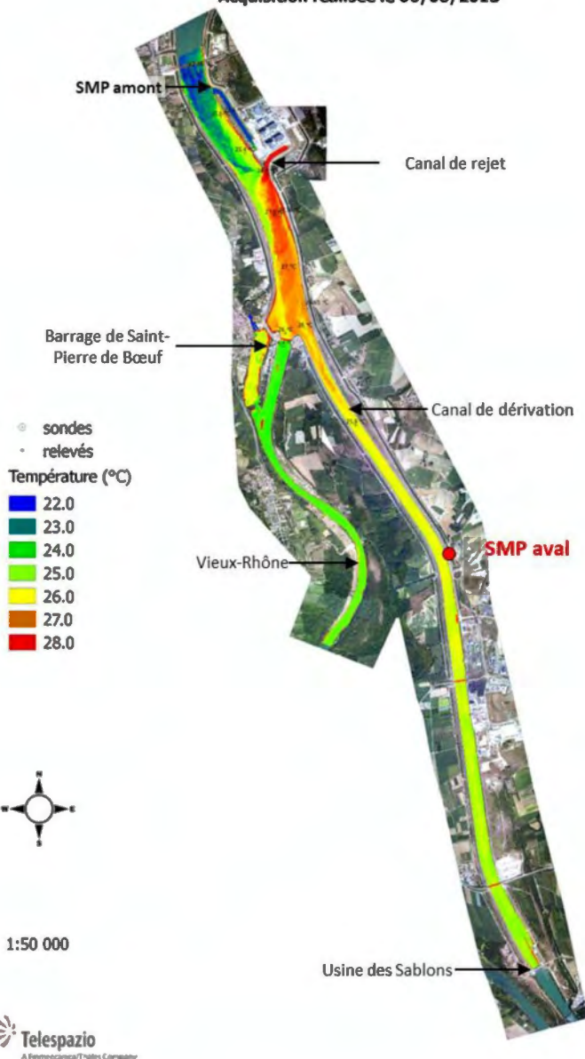
"Thermographie aérienne des rejets d'eau échauffée du CNPE de Saint Alban" (altitude de vol 1600m, résolution spatiale de 2m) Acquisition réalisée le 06/08/2015
